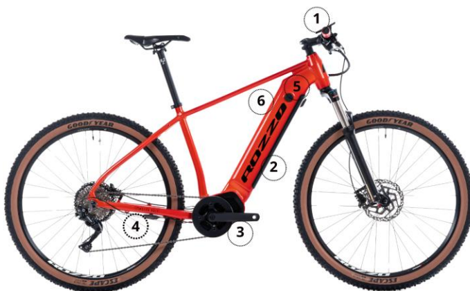
1 - Displej 2 - Baterie 3 - Motor 4 - Rychl. sensor 5 - Nabíjecí konektor 6 - Zámek
